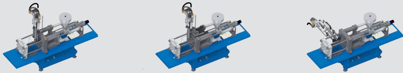
Positionierungsbeispiele für das Spritzaggregat: Vertikal direkt auf dem Werkzeug oder auf der festen Schließplatte oder Horizontal quer liegend
