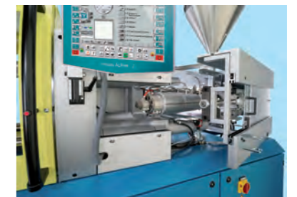
Die ausschwenkbare Spritzeinheit erleichtert Umrüstungen und Wartungsarbeiten
